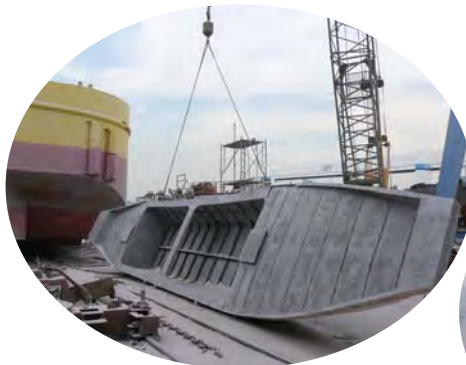
サンドブラストで塗装をはがし、腐食の除去などを行う。
