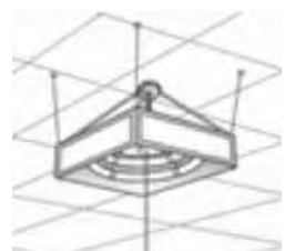
照明器具の固定
