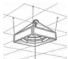
照明器具の固定
